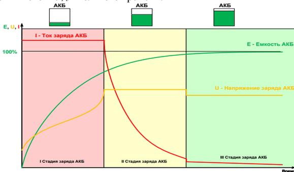
Рисунок 1 (Процесс заряда аккумуляторной батареи).
