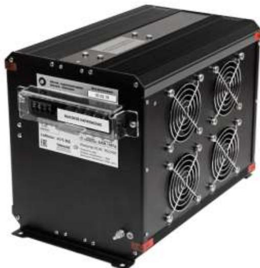
Инвертор **СибВольт 4075 ЖД** (преобразователь напряжения) предназначен для работы на подвижном составе железнодорожного транспорта и преобразования напряжения источника постоянного тока - аккумулятора с номинальным значением напряжения 75 В в переменное синусоидальное напряжение 220 В, частотой 50 Гц для подключения любых нагрузок по мощности в зависимости от типа преобразователя.
