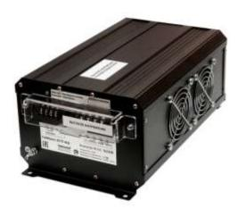
Инвертор СибВольт 2075 ЖД (преобразователь напряжения) предназначен для работы на подвижном составе железнодорожного транспорта и преобразования напряжения источника постоянного тока - аккумулятора с номинальным значением напряжения 75 В в переменное синусоидальное напряжение 220 В, частотой 50 Гц для подключения любых нагрузок по мощности в зависимости от типа преобразователя.
