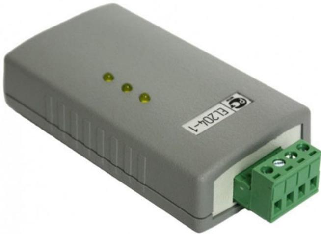
Преобразователь интерфейсов USB - RS485 - RS232.
